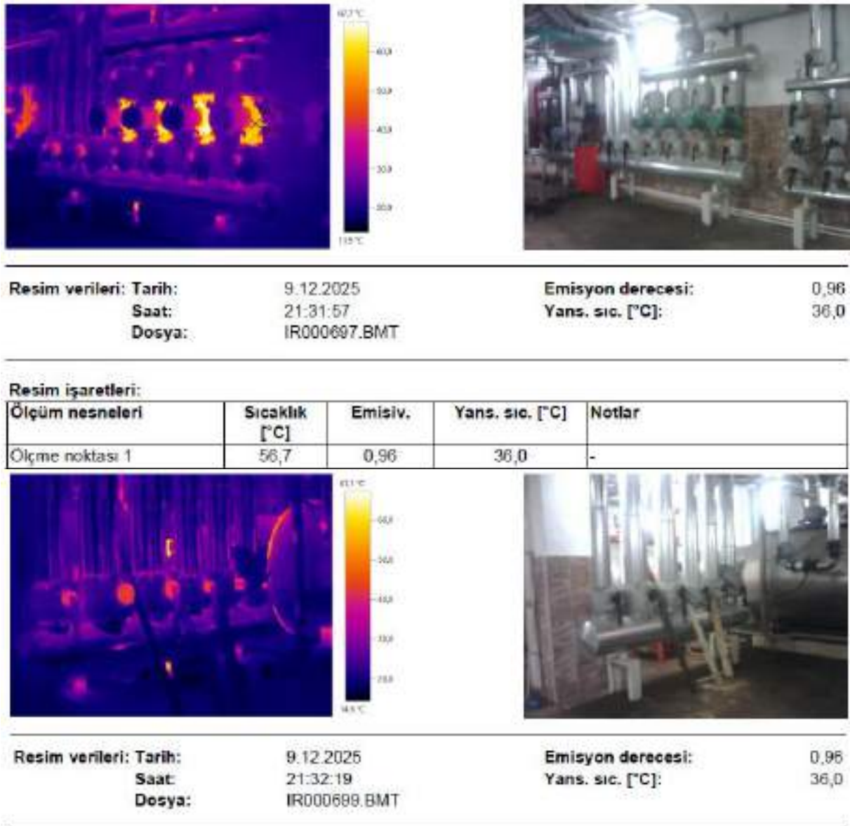
Grafik 20. Yalıtımsız Tesisat Termal Kamera Görüntüleri
